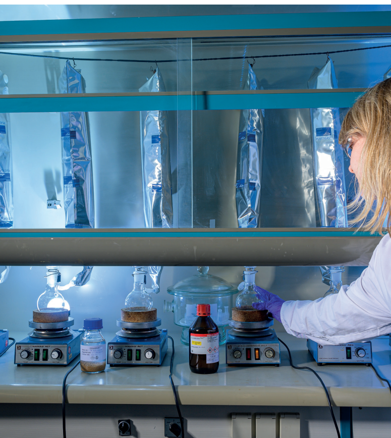
Labora Aufbau zur Bestimmung der NER Typ 1 (Silylierung). Bildquelle: © Fraunhofer IME | Klaus-Peter Kappest
